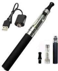
La cigarette électronique (aussi parfois appelée vape, atomiseur ou vaporisateur) est un appareil électronique très simple qui utilise une pile rechargeable pour alimenter un élément chauffant (un brûleur) qui réchauffe le liquide à vapoter et le transforme en une vapeur non toxique qui sera inhalée. Un « atomiseur » conserve le liquide à vapoter dans un « réservoir » et des mèches trempent dans le liquide à vapoter pour en aspirer la bonne quantité vers le serpentin, produisant
